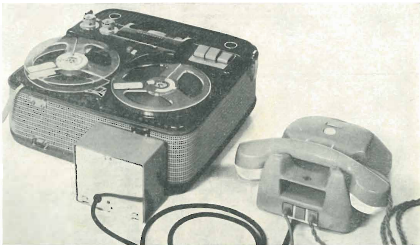
« Qui apparecchio automatico di chiamata e risposta... » Sfruttando le possibilità offerte dalla tecnica delle quattro piste gli ingegneri della TELEFUNKEN hanno realizzato, mediante l'impiego del registratore a nastro di grande seric « Magnetophon 76 », che viene accoppiato con un'unità pilota, l'apparato di chiamata e risposta. (Foto TELEFUNKEN)
